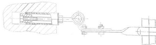
**Схема крепления лесов к стене**
