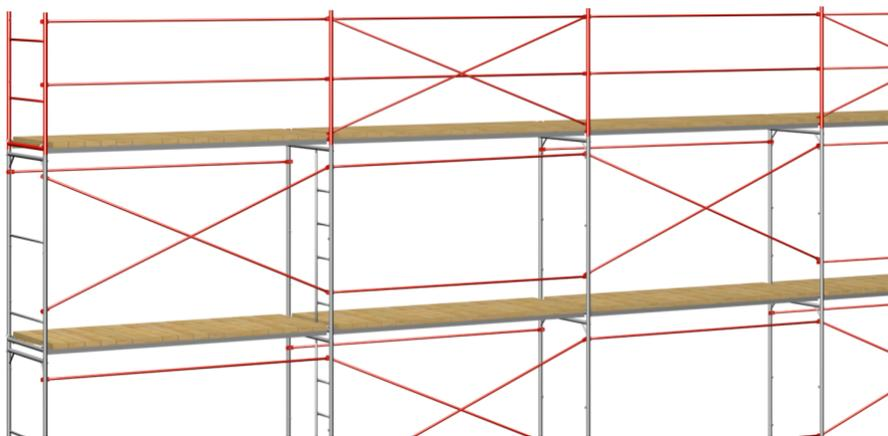
4.7. Укладку настилов и установку связей ограждений следует производить одновременно.
